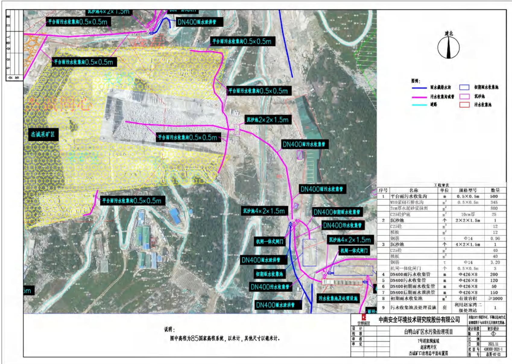
附图 7-8 项目矿区雨污治理设施分布图（7号胡家洞流域-1）
