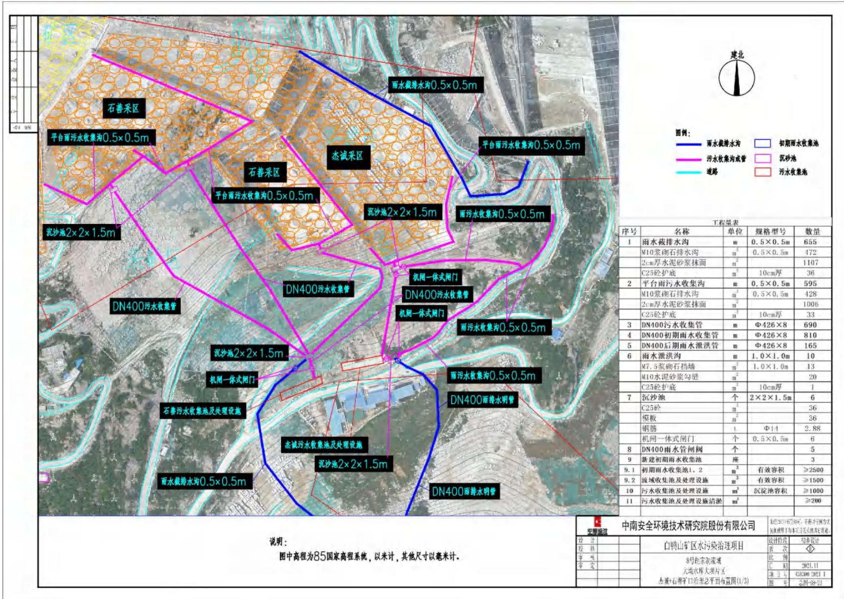
附图 7-11 项目矿区雨污治理设施分布图 (8号胡家洞流域-1)
