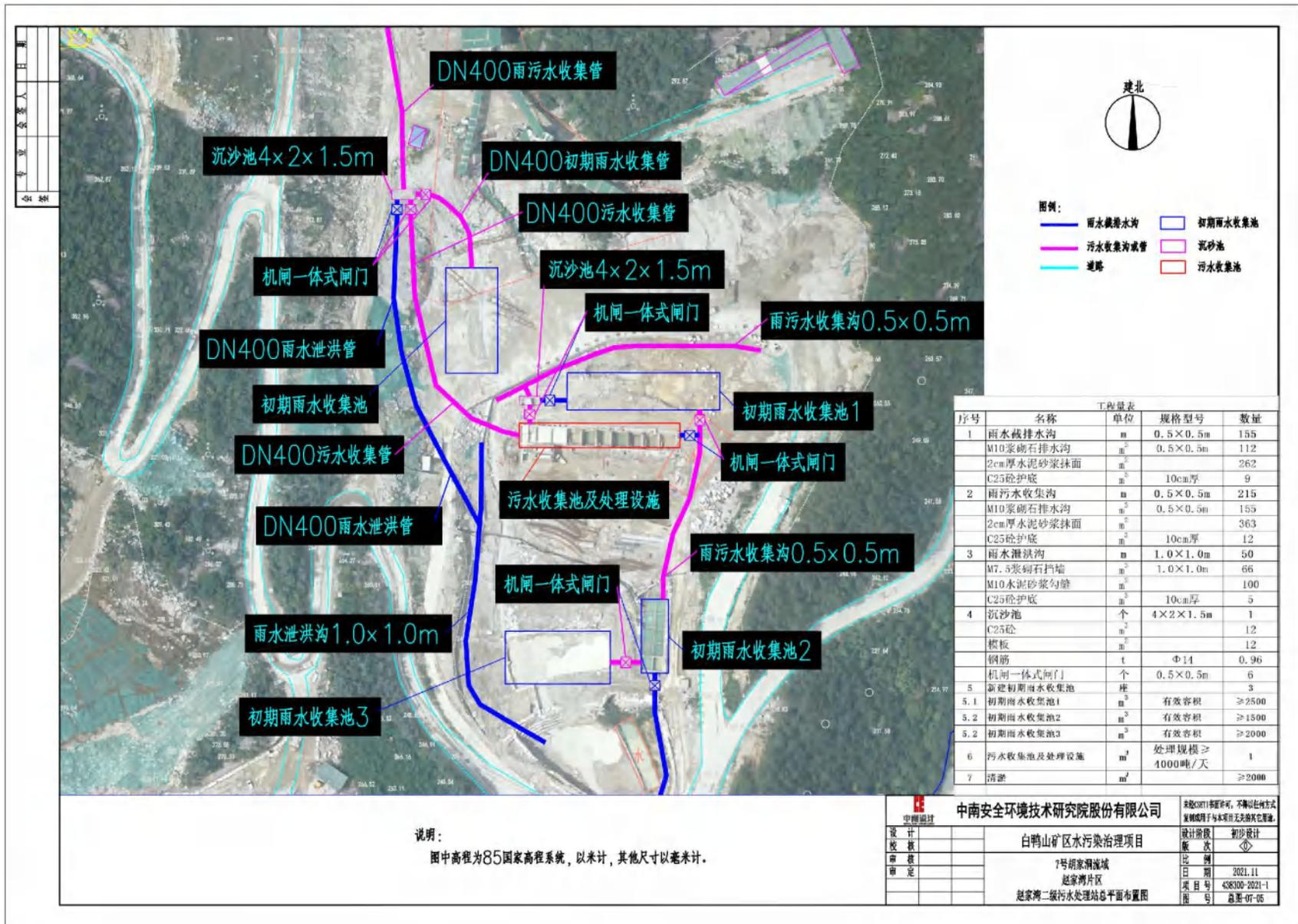
附图 7-10 项目矿区雨污治理设施分布图 (7 号胡家洞流域-3)
